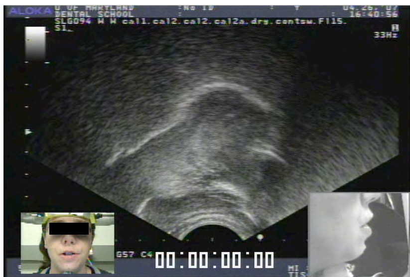
Figure 2.16 : Image extraite de la base de données B1, construite à l'aide du système SA1. Les images vidéo sont incrustées dans l'image ultrasonore à l'aide d'un mélangeur vidéo analogique.
