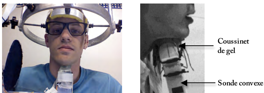
Figure 2.4 : Système de fixation « tête-sonde » HATS
