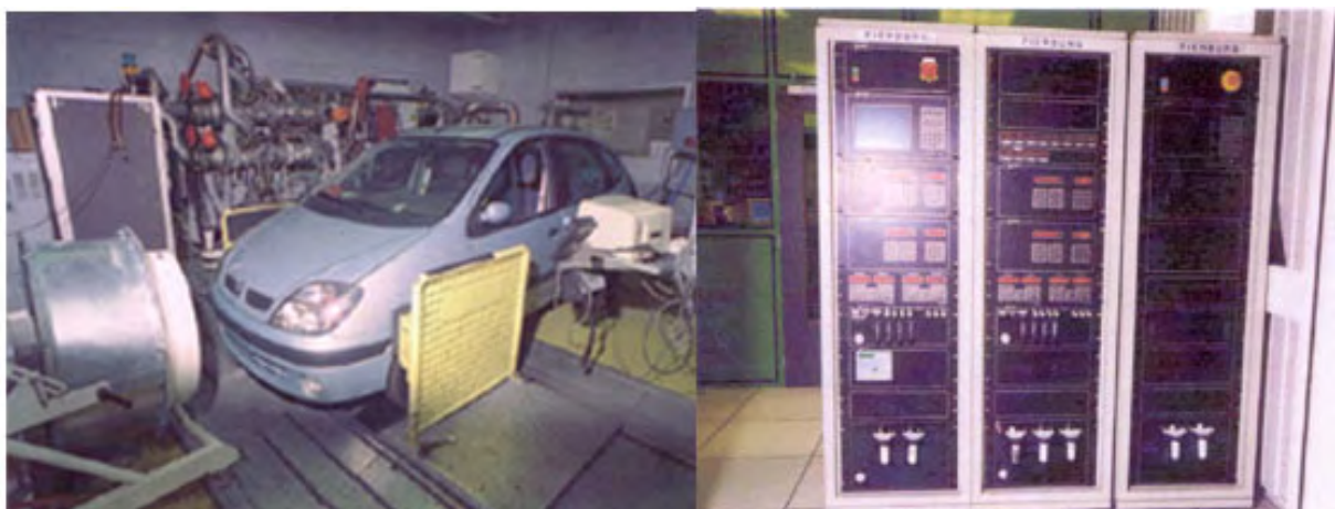
Figure 12 : gauche : banc à rouleaux (BAR) pour la mise au point véhicule. droite : baie d'analyse des gaz polluants.
