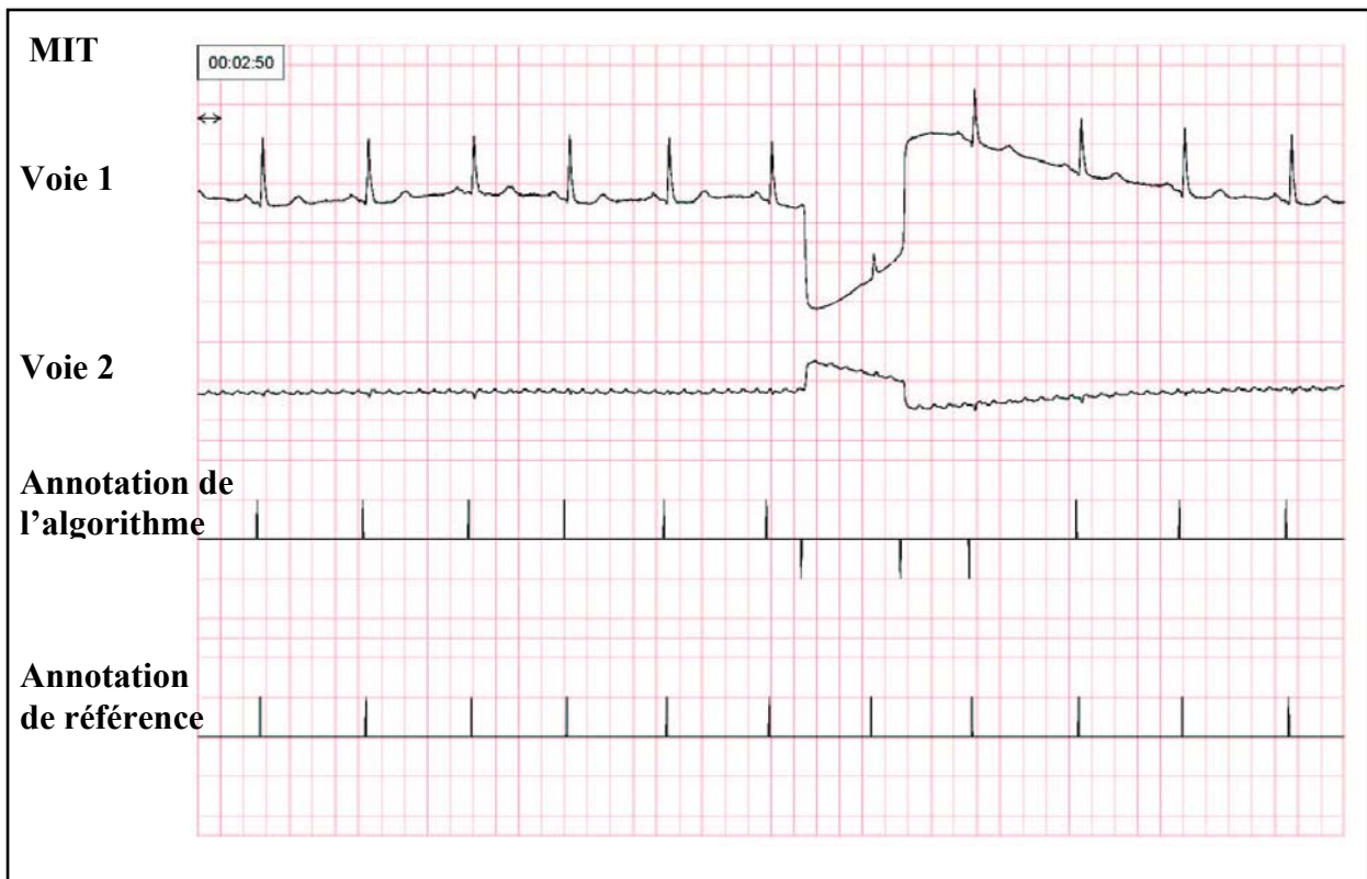
Figure 1 : Pendant cet enregistrement, il y a eu un bruit simultané sur les deux pistes. L'algorithme a alors repéré un complexe en trop. Cependant, celui-ci est rejeté (marque orientée vers le bas). On remarque que les deux complexes QRS suivants, bien que correctement repérés, sont également rejetés : les deux pistes sont en effet encore trop bruitées.
