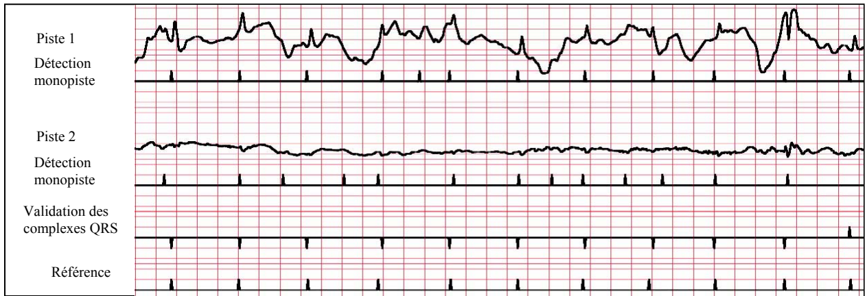
Figure 18 : Sur cet enregistrement (MIT 105) les deux voies sont très bruitées. En sortie, l'algorithme présente les indices de repérage des ondes R à l'envers pour signaler que les deux pistes ne sont pas fiables
