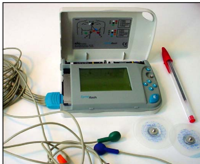
Figure 5: Enregistreur Syneflash® de la société Ela Medical. Le signal cardiaque enregistré pendant 24 heures est stocké sous forme numérique à 200Hz sur une carte à puce du type
