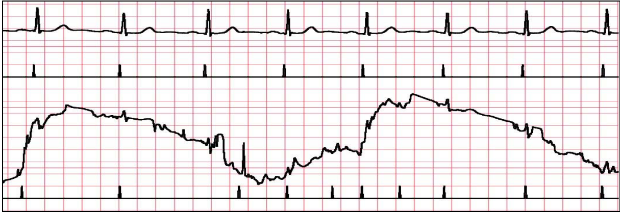
Figure 10 : Cas de bruit BF sur la deuxième voie, la détection sur cette voie est fausse
